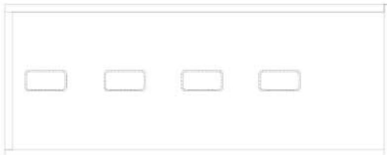
Vista Lateral direita com recortes de ventilação
