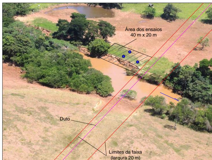
Figura 2 – Indicação da área onde os ensaios devem ser realizados (área hachurada). Os pontos de cor azul representam a localização aproximada das sondagens e coletas de amostras para os ensaios.
